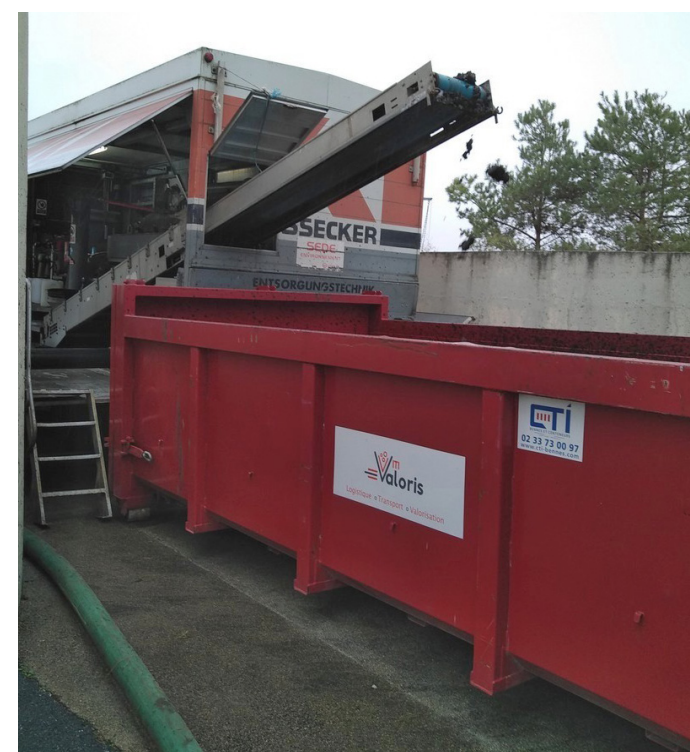
Une benne réceptionne les boues déshydratées (Crédit photo CCSSOM)
