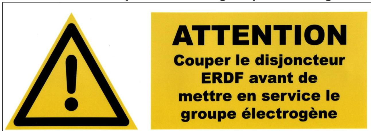
2. Panneau à placer sur le boîtier de comptage extérieur ou le transformateur après coupure de votre disjoncteur (ou compteur) et en notant vos nom et adresse au dos.
