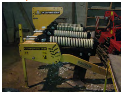
Fissureur - ameublisseur Agrisem® (bâti droit + dents droites + socs à pointes décalées)
