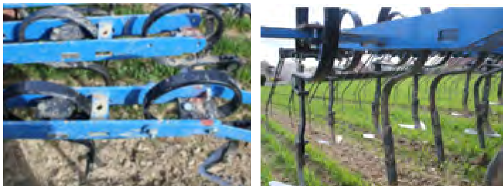
Dents combinées sur une bineuse (Chambre d'agriculture 77)
