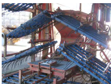
Herse étrille Hatzenbichler® équipée d'un semoir à petites graines (dents inclinées vers l'arrière)
