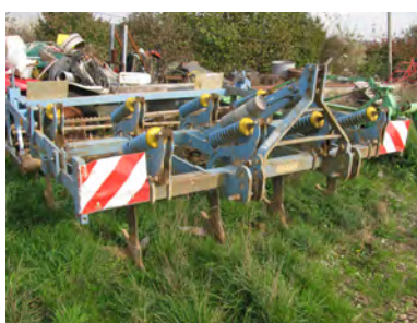
Fissureur - déchaumeur polyvalent Actisol® (dents droites + socs à ailettes ou à pointes)
