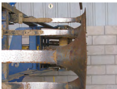
Déchaumeur - scalpeur Treffler®, Morris® (dents incurvées et grands socs pattes d'oie)
