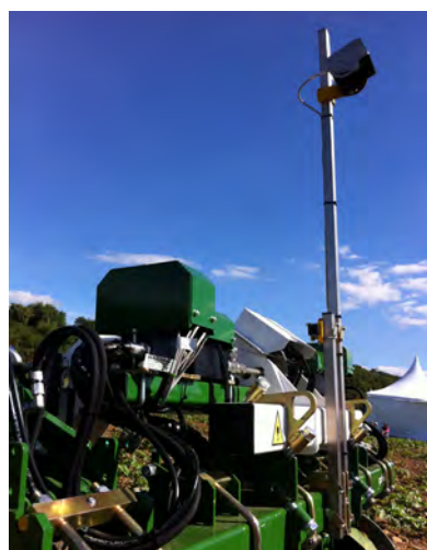
Bineuse caméra de marque Garford. La caméra est fixée sur le mat.
