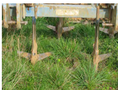
Fissureur - déchaumeur polyvalent Actisol® (dents droites + socs à ailettes ou à pointes)
