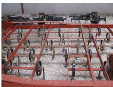
Vibroculteur Knerveland® (dents incurvées et petits socs pattes d'oie)
