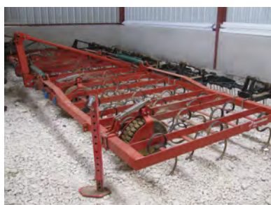
Vibroculteur Knerveland® (dents incurvées et petits socs pattes d'oie)
