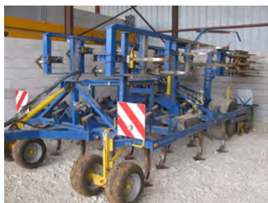
Déchaumeur - scalpeur Treffler®, Morris® (dents incurvées et grands socs pattes d'oie)
